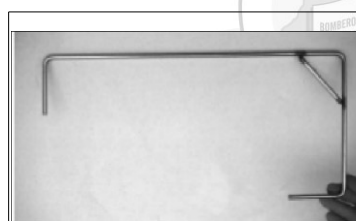
Ilustración 3: La herramienta en forma de "J" se utiliza para manipular la barra antipánico de las puertas batientes dobles.
