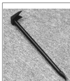
Ilustración 2: La herramienta de pata de cabra para arrancar los cilindros de la cerradura.
