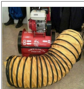
Ilustración 5: Extractor con ducto.
